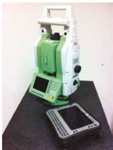
THÉODOLITE MOTORISÉ ET SON TERMINAL DE SAISIE PORTABLE (TSP)
