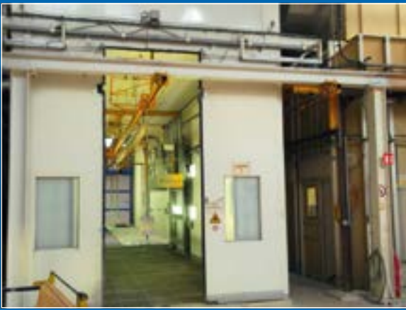
Cabine peinture préchauffée par chaleur récupérée sur compresseurs
